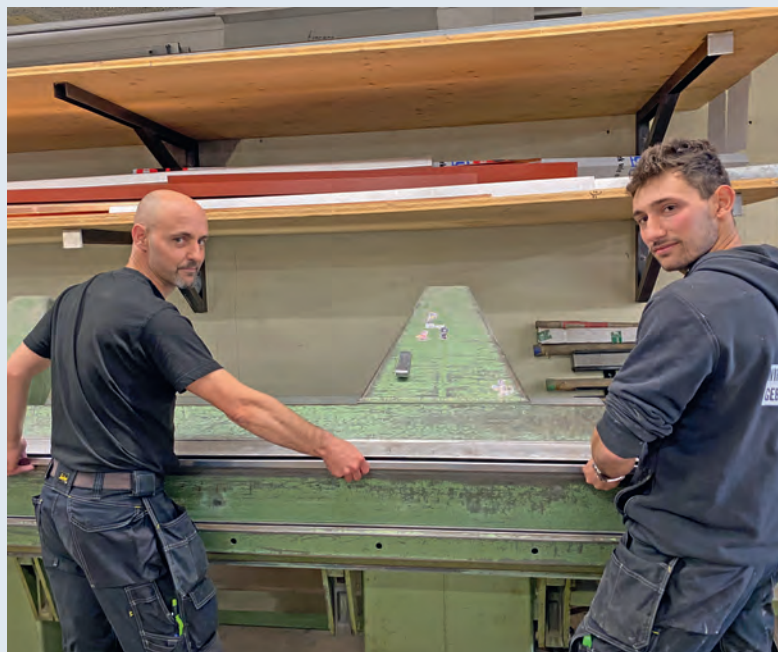
Spezialmaschinen braucht es auch hier: Roger Zanin (links) und Marcel Bollhalder kanten ein Blech ab.
